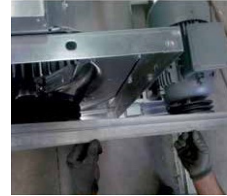
Resim 6. Kasnakların hizasının kontrolü-1
