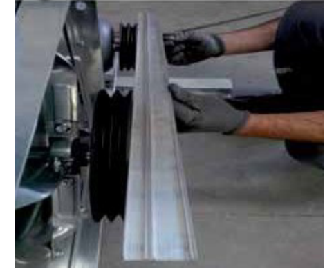
Resim 7. Kasnakların hizasının kontrolü-2
