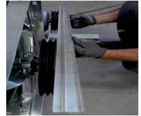
Resim 7. Kasnakların hizasının kontrolü-2
