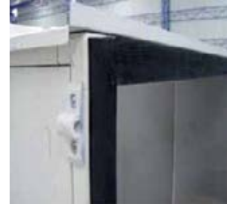
Resim 1. Hücreler arası sızdırmazlık contası
