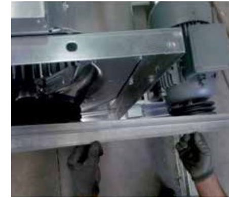
Resim 6. Kasnakların hizasının kontrolü-1
