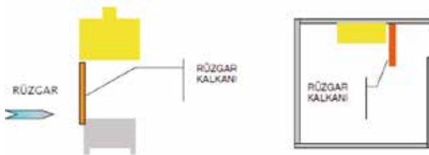
Şekil 40. Davlumbaz Hava Akımının Korunması İçin Rüzgar Kalkanı
